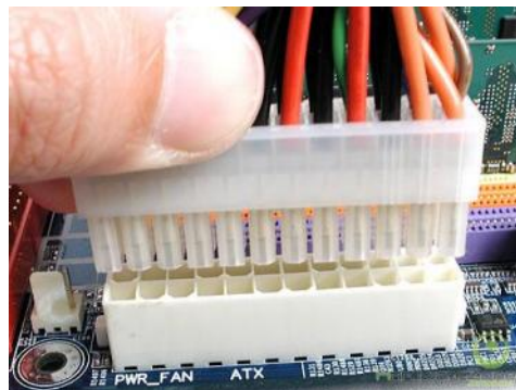
Gambar 2. 4. Konektor power ATX 24 pin
