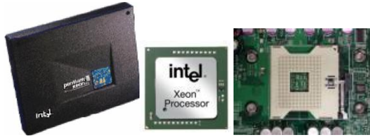
Gambar 2. 11. Prosesor Intel Xeon package SECC2 untuk slot 2 dan Intel Xeon dengan socket 603
